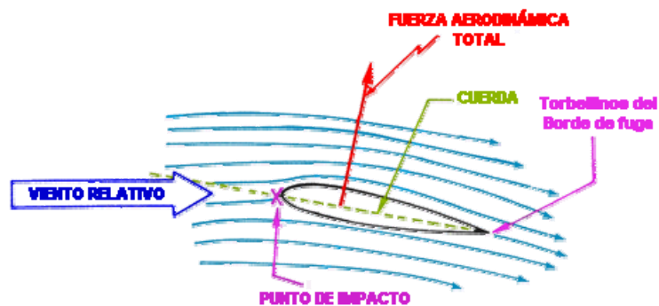
Figura 2-18. FLUJO SOBRE UN PLANO AERODINÁMICO
