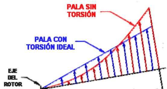
Figura 2-35. DISTRIBUCIÓN DE LA SUSTENTACIÓN SOBRE PALAS CON Y SIN TORSIÓN
