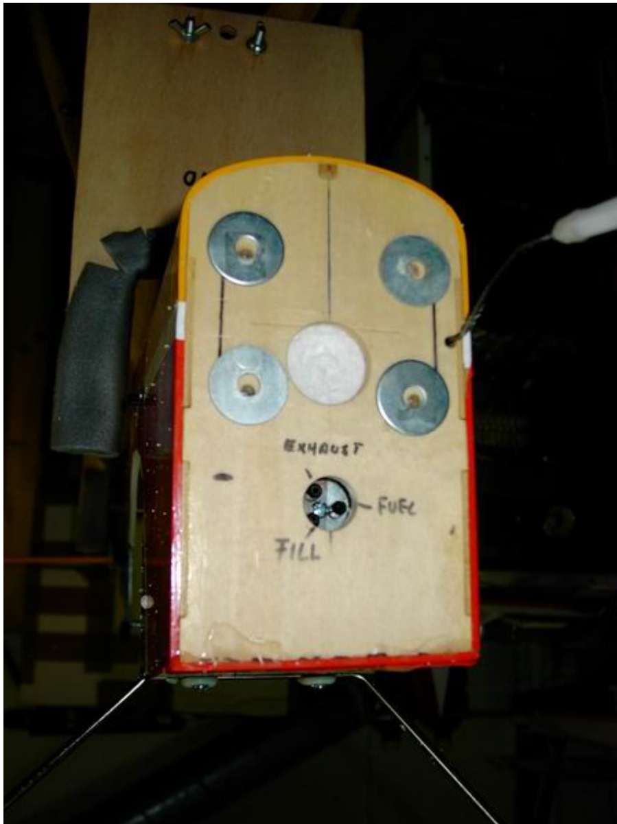
En esta imagen se aprecia perfectamente la nueva posición de la salida del depósito, para la que será necesaria taladrar un agujero en la cuaderna cortafuegos.
